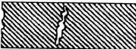
La **porosità chiusa**, inaccessibile all'iniezione di resine e quindi non trattabile mediante impregnazione, non genera perdite di fluidi e di gas. Altresì non presenta controindicazioni ai successivi trattamenti galvanici e di verniciatura. Può essere fatta riaffiorare in superficie in seguito a lavorazioni meccaniche del pezzo diventando così una porosità cieca. Per questo motivo è **sempre buona norma eseguire l'impregnazione dopo le lavorazioni meccaniche**.
